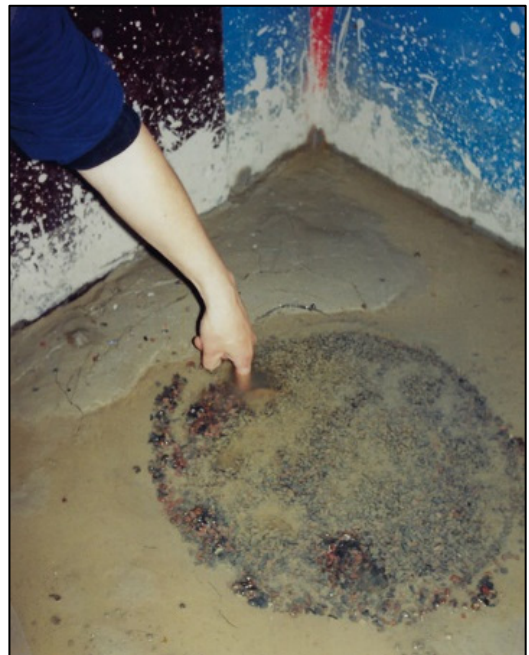
Kuva 4. Kaatokokeen jälkeinen tilanne tutkimuskuopassa. Sylinterin alueelle on jäänyt soraa, yksi paaluhattu on sormen alla ja savea on noussut murtopintaa pitkin.
