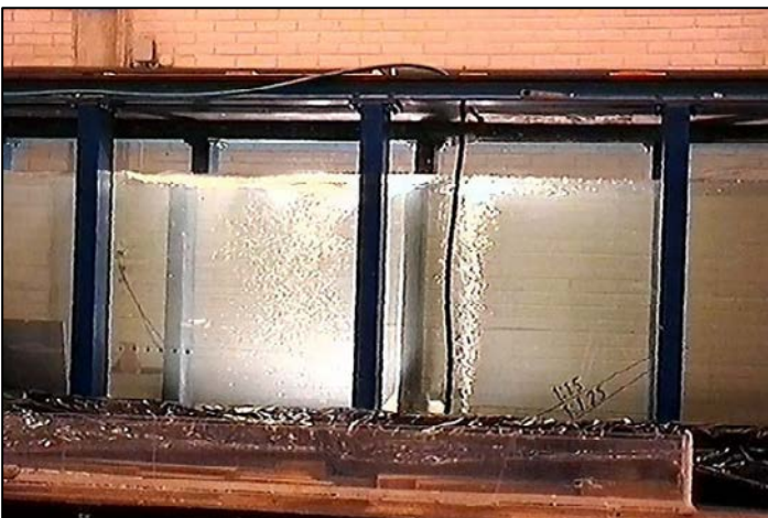
Kuva 5. Pellettejä ja pulputuspuomi
