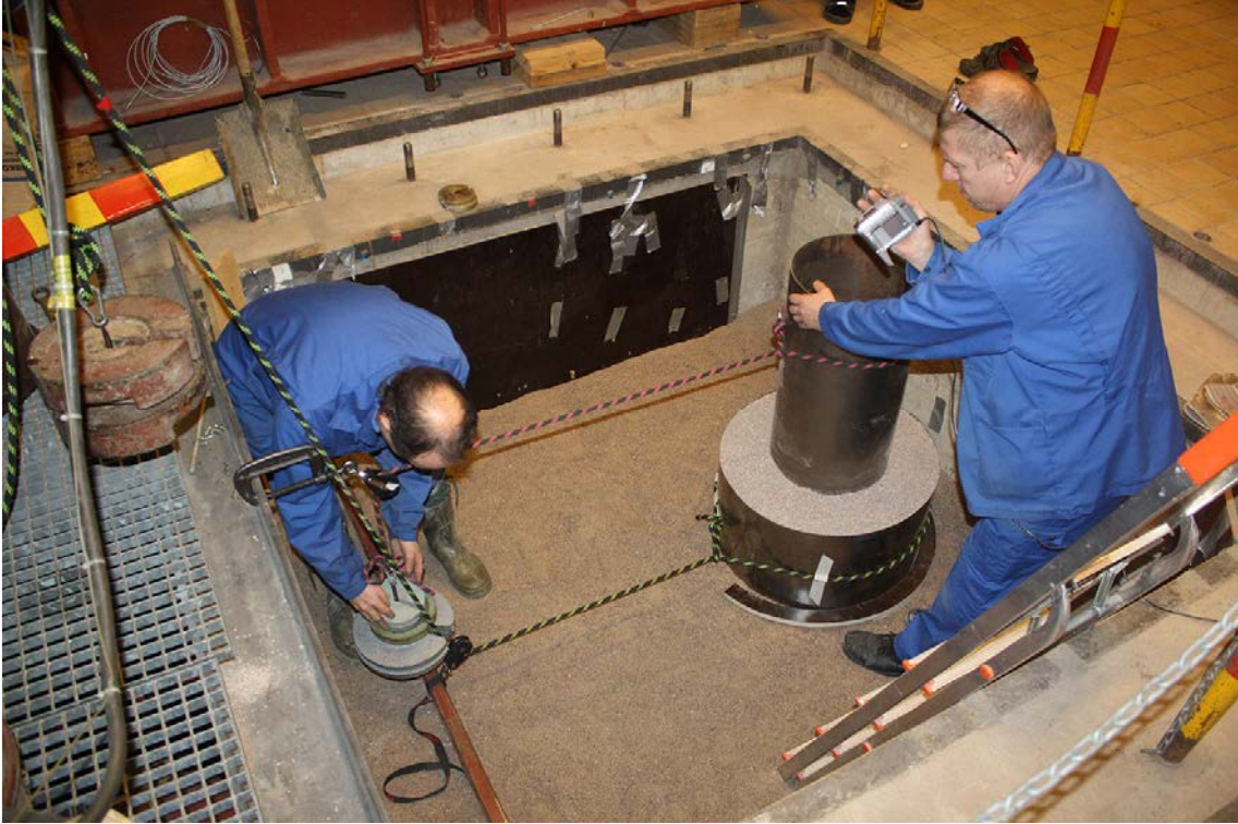
Korotusrenkaalla varustetun teräskuoriperustuksen käyttäytymistä tuuli- ja aaltokuormien alaisena tutkitaan pienoismallikokeessa TKK:n geotekniikan laboratoriossa.
