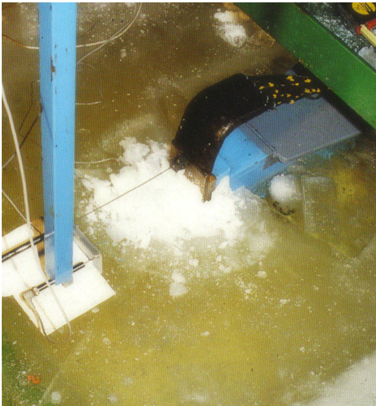
Jään ja rakenteen dynaamisen vuorovaikutuksen tutkimista VTT:n jäätankissa. Olennaista tutkimuksessa oli oikean jään (ei mallijään) käyttö sekä värähtelevän kappaleen ominaisuuksien variointi.
