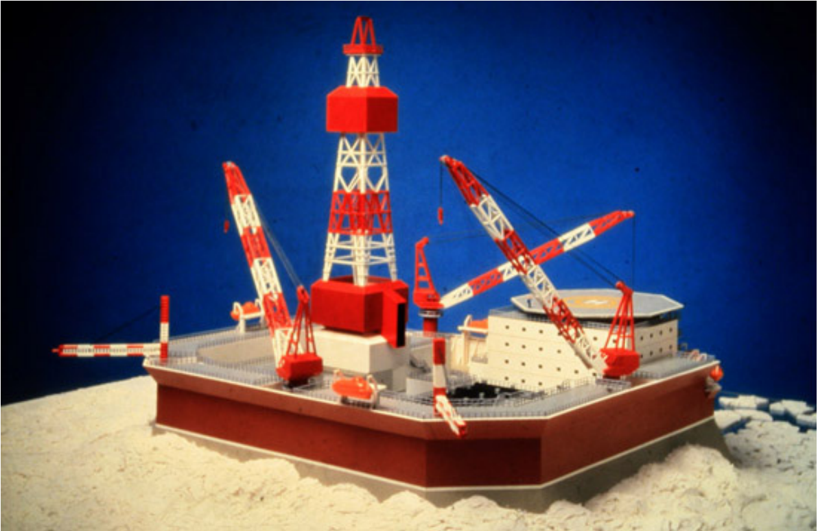
Pienoismalli varsin pitkälle suunnitellusta ACG:n teräsbetonisesta poraustasanteesta, johon kuului myös jäähän ja geotekniikkaan liittyvät monitorointijärjestelmä.
