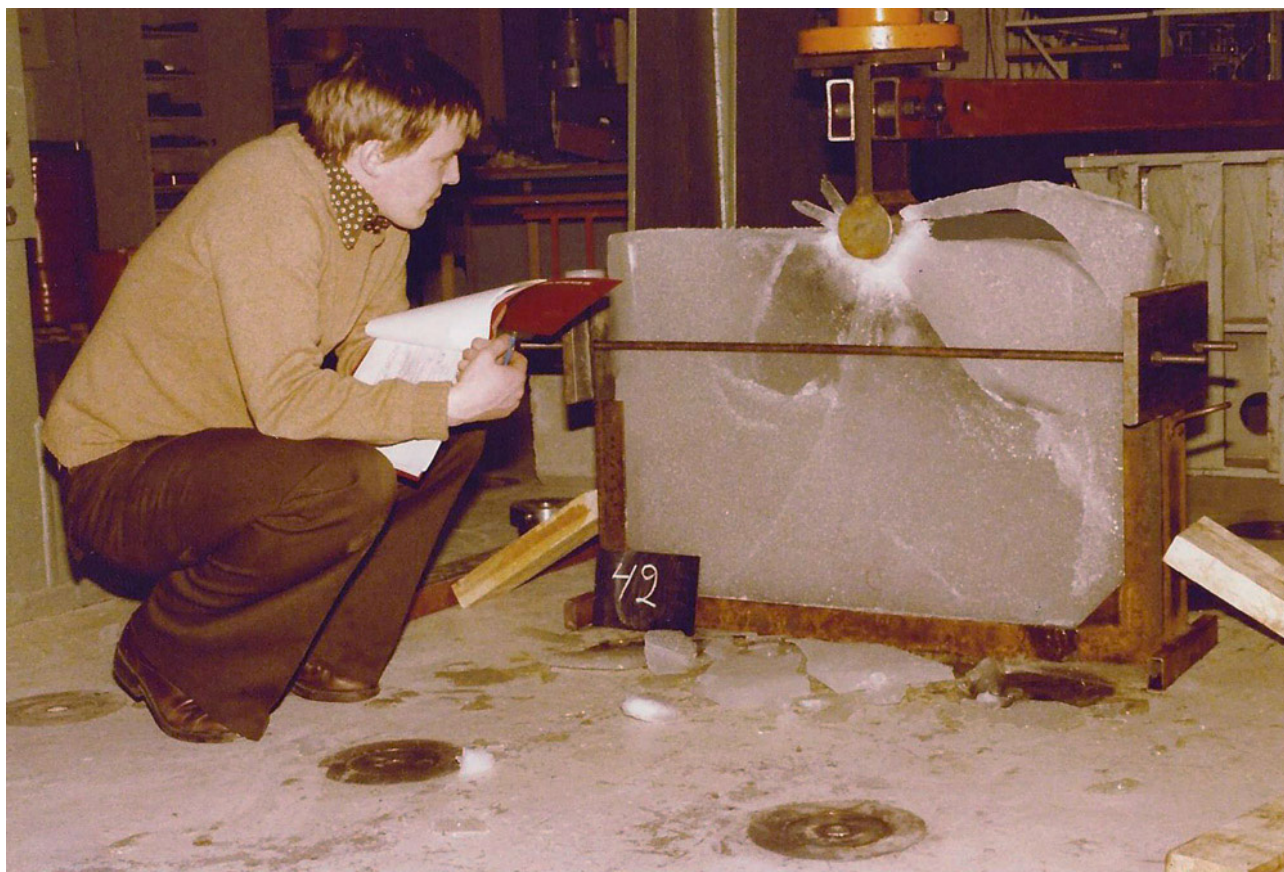
Jään kuormituskokeita TKK:n rakennetekniikan laboratoriossa vuonna 1978.
