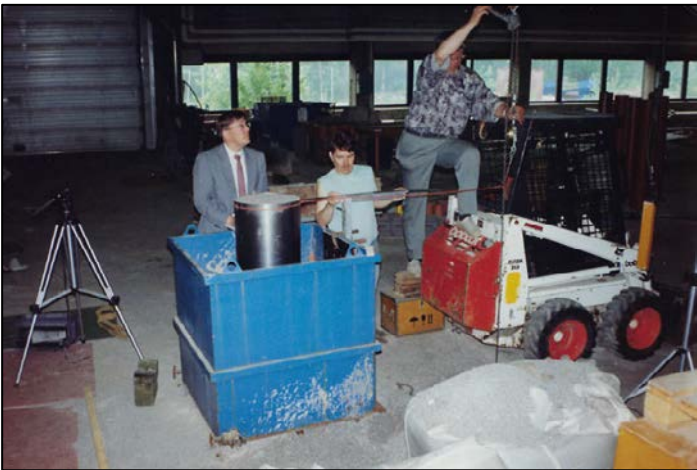
Kuva 3. Savikolle hatuilla varustettujen paalujen varaan perustettua kiviainestäyttöistä terässylinteriä kaadetaan.
