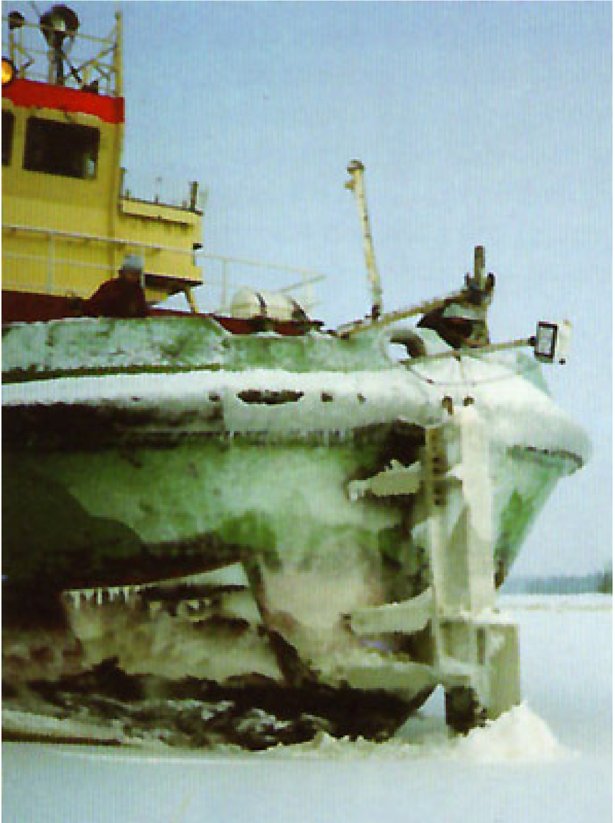
Betonin kulutuskestävyyttä tutkittiin ajamalla jäänmurtajan keulaan kiinnitetyjä koekappaleita jääkenttien läpi. Samalla saatiin täysmittakaavatietoa jään murskauslujuudesta rakennetta vasten.
